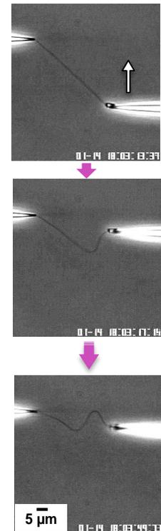
図 3 変形により誘導された屈曲形成(中段)、およびそれに続いて起こった振動(下段)。
