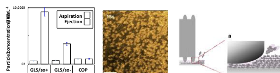
図2 シリンジからの押出による凝集体増加（左）ガラス表面への抗体の吸着の様子（中央）凝集体発生モデル（右）
